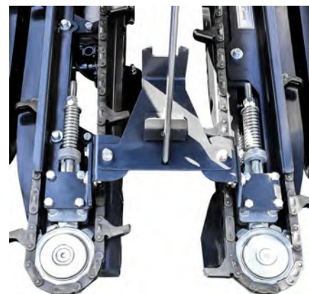
A kivezetett kenési pont megkönnyíti a karbantartást
