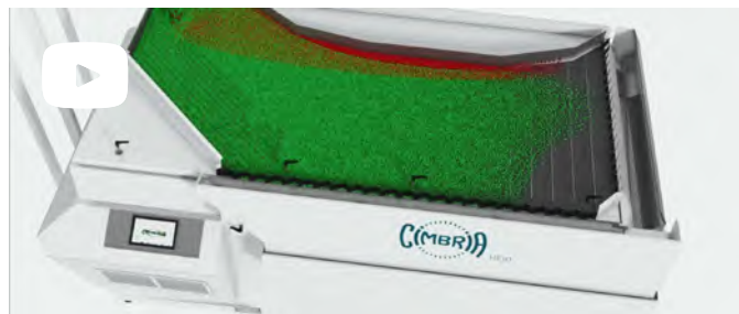
A szivacsos szerkezet miatt a kisebb fajsúlyú kukoricaszemek a Cimbria Heid fajsúlyszeparátorral eltávolíthatók
