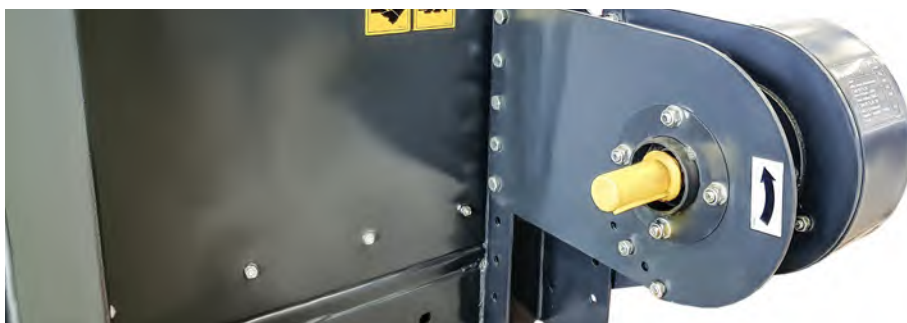
A behordócsiga zsírpontja és a láncfeszítő állítása is kívül van elhelyezve a hajtásházon
