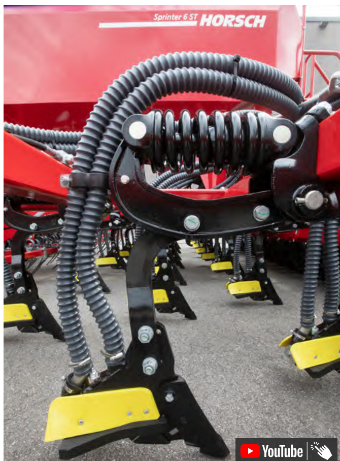
Duett csoroszlyavetés-műtrágyázás egy menetben, két síkban
