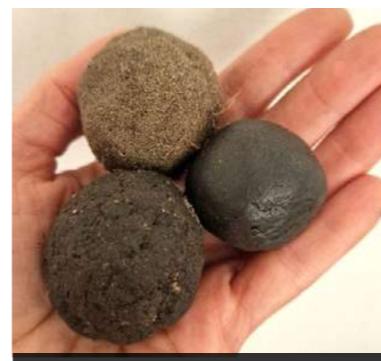
Gyűrőpróba különböző fizikai talajféleségeken (a szerző felvétele)
