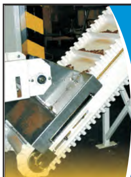
Hullámperemes-bordás szállítószalag, ömlesztett áru emelkedő szállítására
