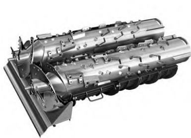
2. ábra: Axiáldobos cséplő- és tisztító-szerkezet
