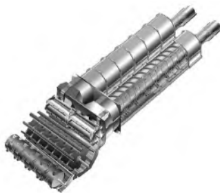
3. ábra: Forgó szalma-leválasztású arató-cséplő gépek cséplő- és tisztító-szerkezete
