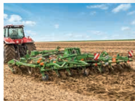
Ceus – 30 cm munkamélységben is kiváló munkát végeznek a C-MIX kapák
