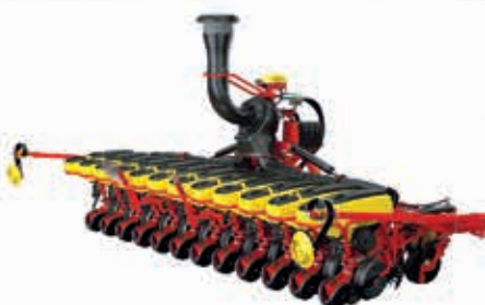
Tempo V12 függesztett vetőgép, 45 cm-es sortávolsággal
