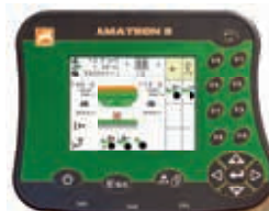
A csoroszlyák nyomása 10 fokozatban, távvezérléssel, kényelmesen beállítható az ISOBUS-terminálon keresztül
