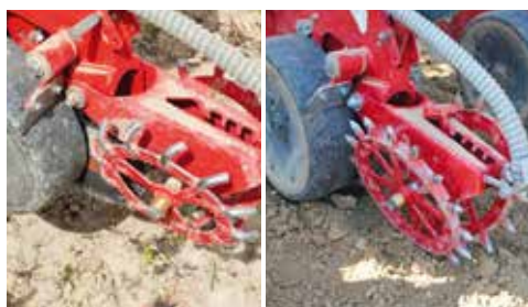
Különböző nyomókereket különböző talajokra: – újjas nyomókerék az igen kötött talajokra (bal oldal), – tüskés nyomókerék az üledékes talajokra (jobb oldal)
