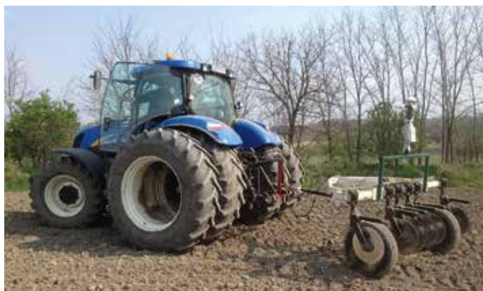
A Veris-3100-as mérőműszer beállítása a kísérleti táblán
