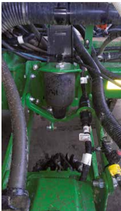
4. kép: A pneumatikus talajnyomás fokozó rendszer
