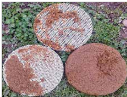
3. ábra: a trágyaszeparátor eredménye: felső tálca: 5%, középső tálca: 10%, alsó tálca: 85%
