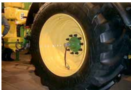
2. ábra: központi belső levegőnyomás-szabályzó vezeték
