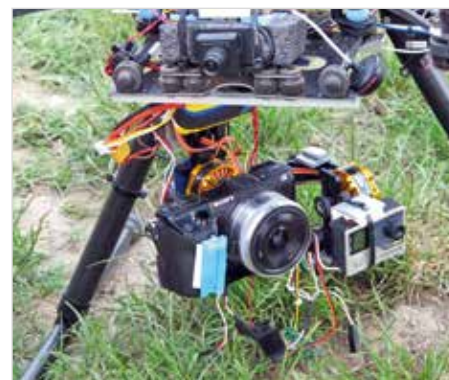
2. kép: egy előre tekintő láthatófény tartományú kamerával, illetve több adatrögzítő kamerával ellátott UAV (forrás: FlyBySense)
