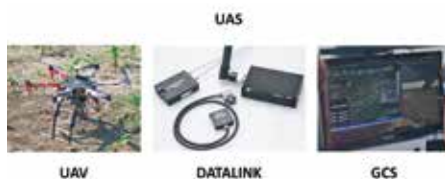
1. kép: az UAS-t felépítő legfontosabb rendszerelemek
