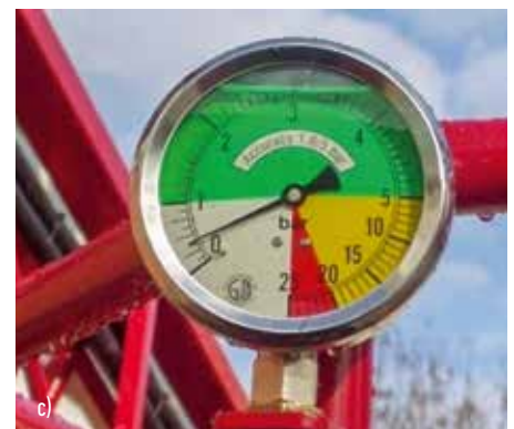
3. ábra: főbb hiányosságok szántóföldi permetezőknél, a-b) szórófeje, szóróképp hiba, c) manométer hiba, d) vezetékek rendszer hibája, e) armatúra hiba, f) szórókeret-deformáció
