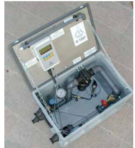
1. ábra: Herbst ROT-650/60/40/10 kombi armatúra mérőtáska
