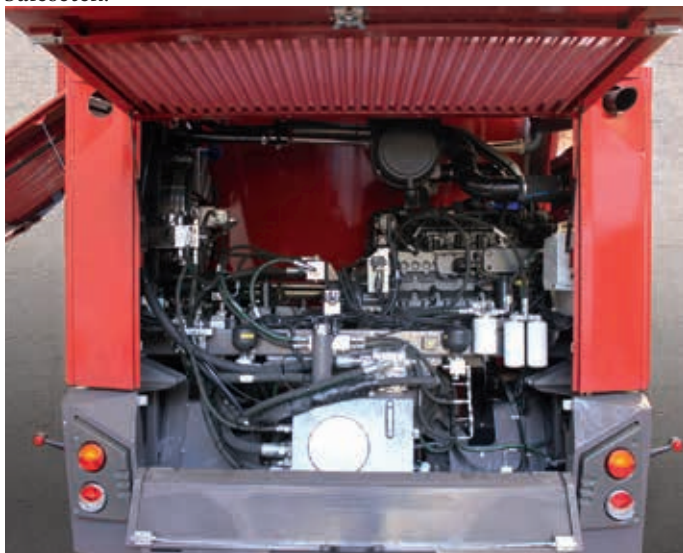
A gépkezelők álma, szellős motortér, minden részegységhez könnyű hozzáférni, sűrített levegővel egyszerűen tisztítható
