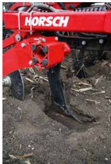
Focus 6 TD műtrágya lehelyezése a művelési mélységbe
