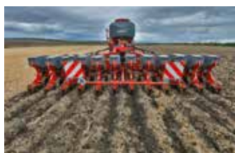
A Maestro a kapák nyomába helyezi a vetőmagot
