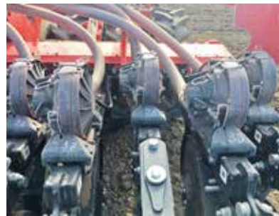
Speciális soronkénti szemenként adagoló vetőegységek
