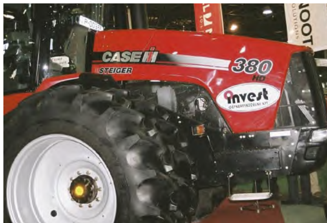
8. ábra: A STEIGER STX 380 kerekes törzscuklós traktor 516 LE teljesítményű motorjával és kettős törzscuklós építésével jelentett vásári újdonságot
