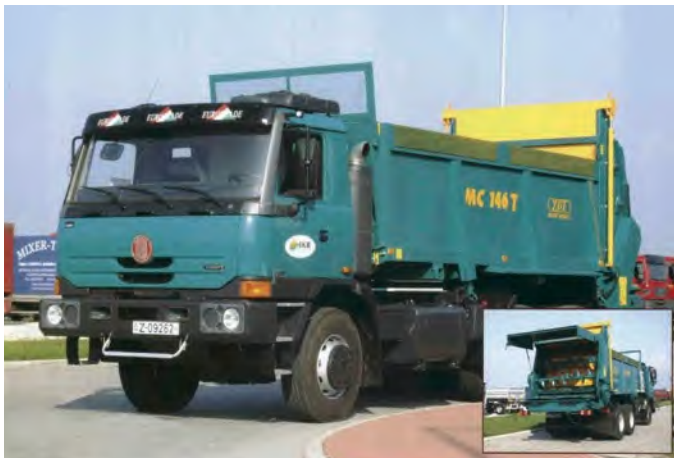
5. ábra: A mezőgazdasági szállítás fontos gépe lehet a cserefelépítményekkel – billenő kocsiszekrény szerves- és műtrágyaszóró, tartályos felépítmény – felszerelhető összkerek-hajtású TATRA 815 29R25/371 6 × 6,2 tehergépkocsi
