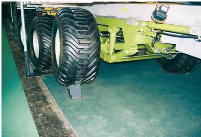
6. ábra: A Fliegl-Abda által kialakított GIGANT letolólapos pótkocsi három tengelyes kormányzott futóműve
