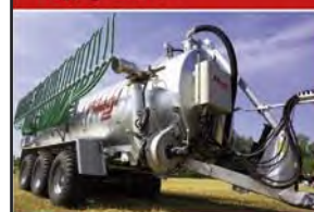
Tartálykocsi csigás földfelszíni terítő egységgel
