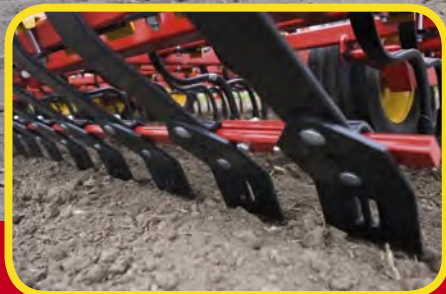
Crossboard, menet közben is állítható simító, mely kiváló felszín-egyengető és rögtörő hatású
