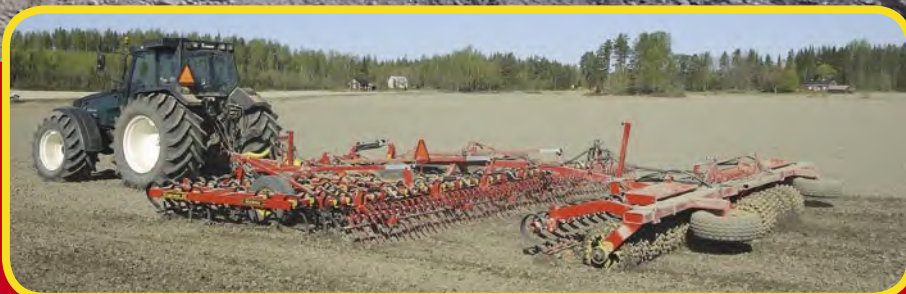
Az NZA modellekre tetszés szerint Rollex vagy Rexius hengerek kapcsolhatók
