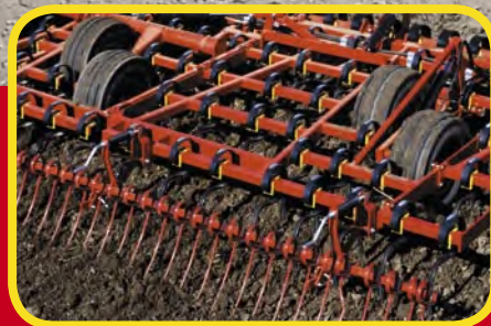
Tandem kerekeken hidraulikusan szabályzott mélységállítás
