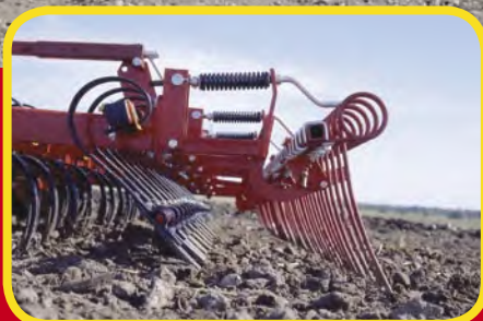
A hátsó simító és a követő borona tökéletes lezárt felszín hagy vissza
