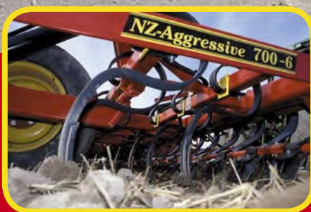
Erős AGrilla Cobra kapák 5 sorban, 7,5 cm osztásban
