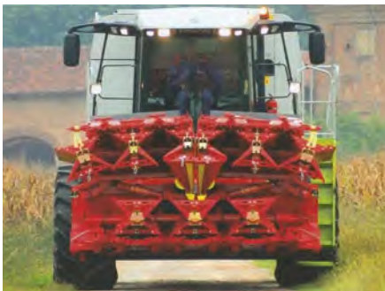
5. ábra: Szállítási helyzetbe állított (összecsukott) adapter
