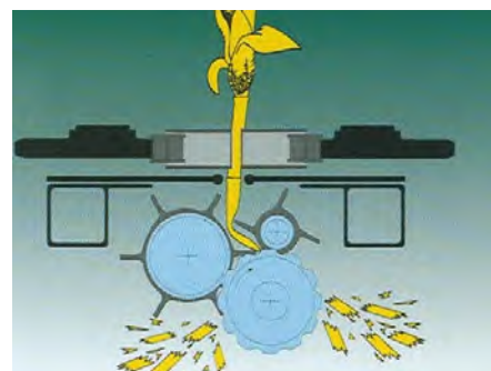
3. ábra: Törőhenger pár szárleválasztó, -aprító késsel (Geringhoff)
