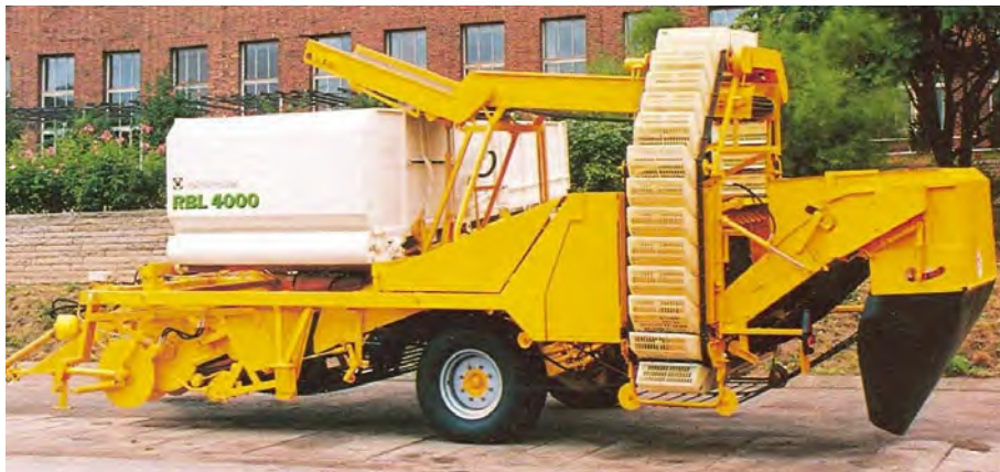
3. ábra: A burgonya betakarító gép serleges felhordóval, válogatóasztallal és tartállyal
