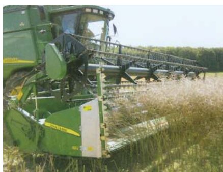
6. ábra: A vágóasztal magasságát az alsó becők elhelyezkedése határozza meg
