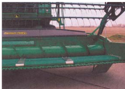
5. ábra: John Deere 9640 arató-cséplőgép Zürn Premium Flow szállítószalagos vágóasztallal
