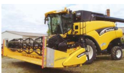
2. ábra: Függőleges rendválasztó kaszák a New Holland arató-cséplő gépre szerelt Zürn vágóasztalon
