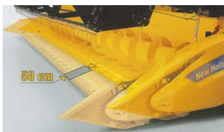
3. ábra: Kitolható kaszaszerkezet a New Holland CSX arató-cséplő gépen
