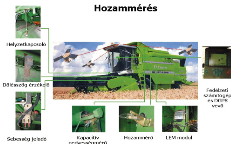
1. ábra: A hozammérő rendszer felépítése és szenzorai
