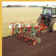
Az ekékre szántáselemző henger is ráépíthető
