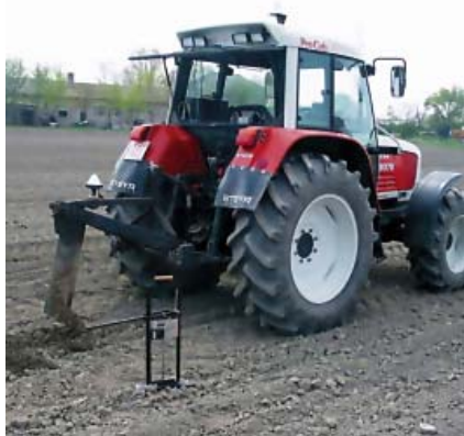
4. ábra: A talajlazítóra szerelt GPS antenna és talajellenállásmérő rendszer, valamint a talajellenállás térkép
