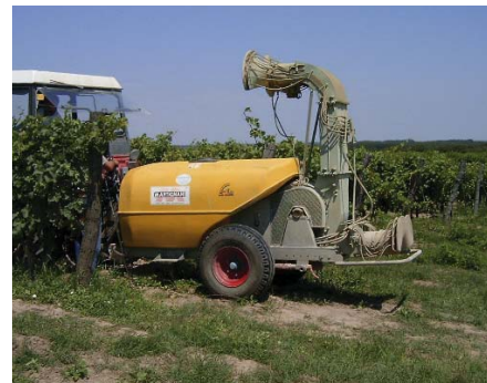
4. ábra: Alagút permetezőgép
