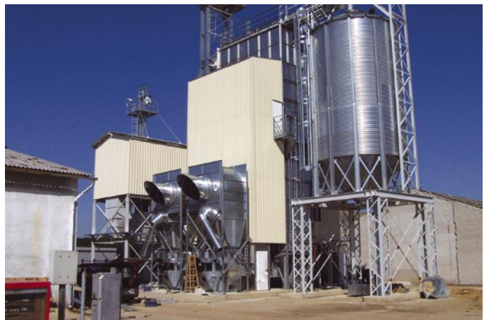
Centrifugális porleválasztók a Kemecsen létesített 32 t/h teljesítményű szárítóberendezésen
