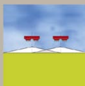
Optimális szórás kép 100%-os átfedéssel
