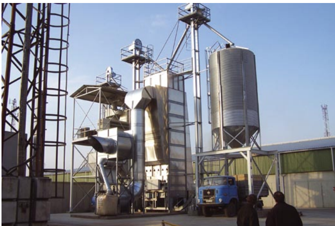
Centrifugális porleválasztóval ellátott UNIVERSAL 25 típusú szárítóberendezés, Nyíregyházán a Kemoker Kft. telephelyén
