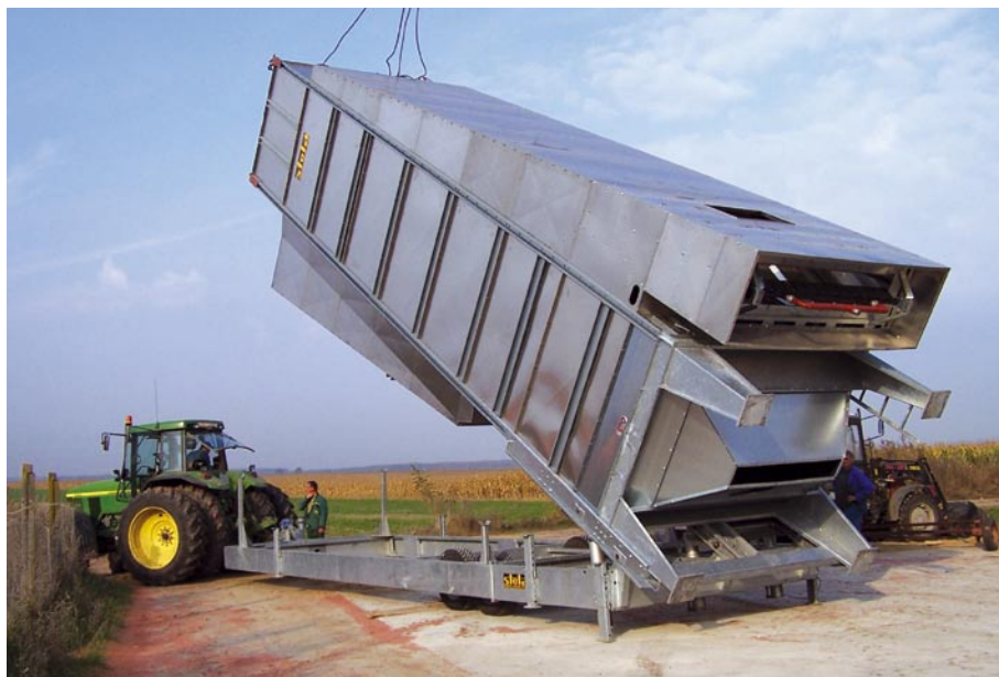
Szárítóberendezés függőleges helyzetbe állítása traktor hidraulikával
