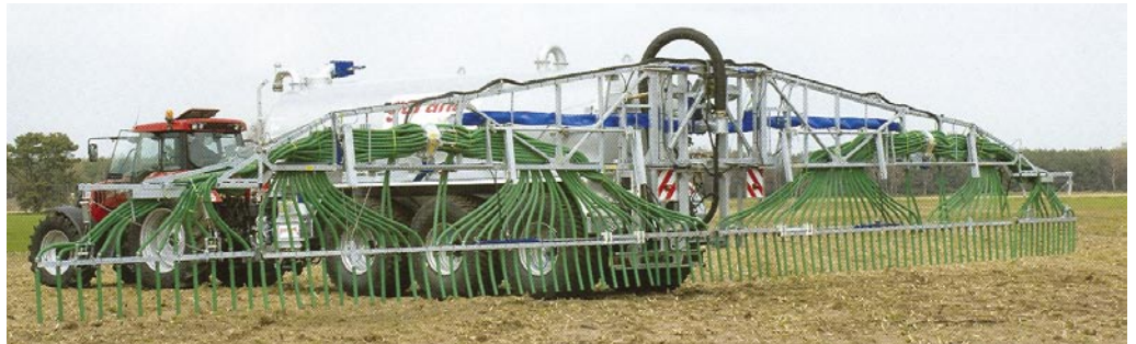
2. ábra: csúszócsöves hígtrágya kijuttató
