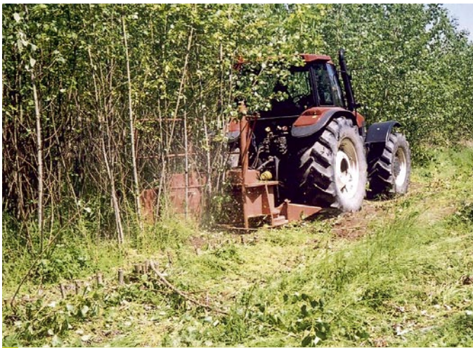
1. kép: Két forgórészes függesztett gép üzem közben
