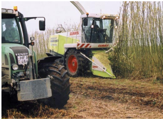
2. kép: Magajáró Claas Jaguar 850-re szerelt adapter munka közben
