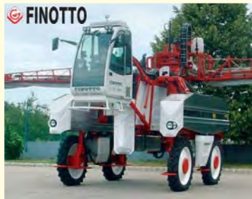
FINOTTO LÉGSZÁKOS PERMETEZŐGÉPEK 3000 literes tartálytérfogat, 18, 21 vagy 24 méteres légszákos szórókeret, 290 cm hasmagasság, állítható nyomtávolság
