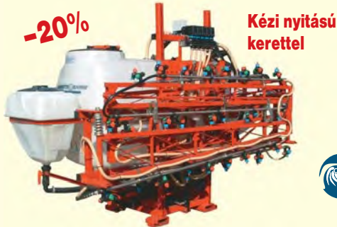
BARGAM (GAMBETTI) PERMETEZŐGÉPEK 600–800–1000–1200 literes tartálytérfogat, 12, 15, 16, 18 vagy 20 méter, munkaszélességű szórókeret
