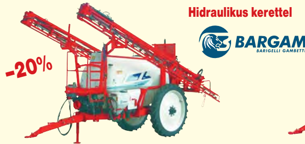
BARGAM (GAMBETTI) PERMETEZŐGÉPEK 2200–2700–3200–3700 literes tartálytérfogat, 15, 16, 18, 20, 21, 24 vagy 28 méter munkaszélességű hidraulikus szórókeret
