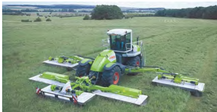
▲ 3. ábra: rotációs kaszával szerelt modern rendrevágó gép
