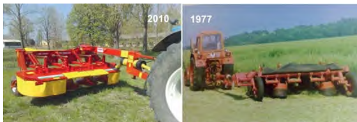
▲ 1. ábra: felülhajtott rotációs kasza független dobelfüggesztéssel
