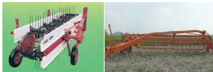
▲ 5. ábra: láncgereblyés rendsodró, és a csatolórudas dobgerblye
