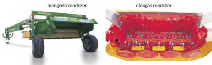
▲ 2. ábra: szársértővel felszerelt rotációs kaszák
