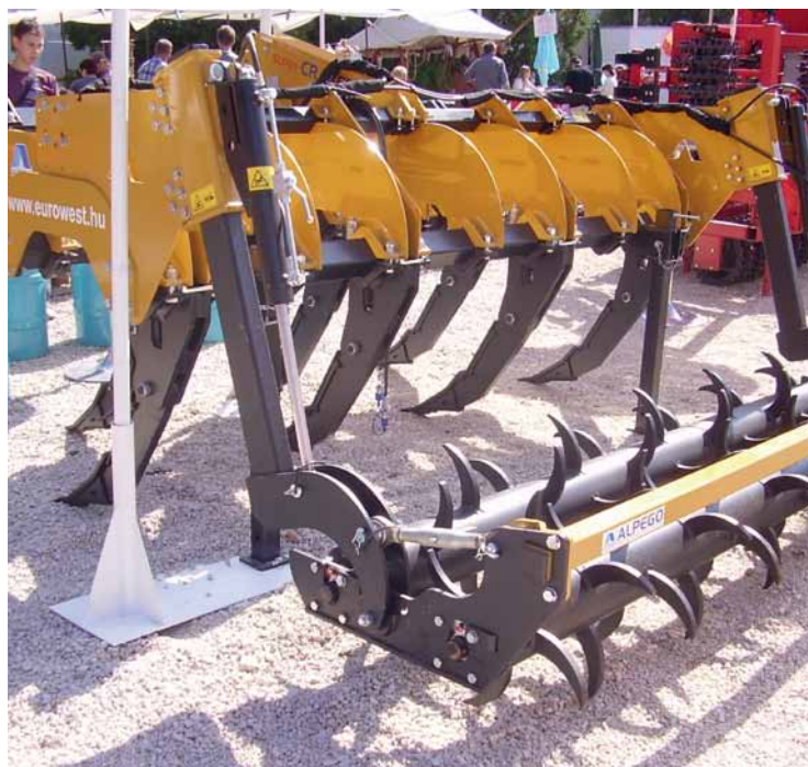
▲ Korszerű lazító, hidraulikusan állítható elmunkáló hengerrel (Fotó: Bottlik, 2008)
