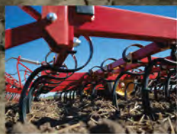
Egyedi kialakítású Agrilla Cobra kapák 5 sorban, 7,5 cm osztásban
