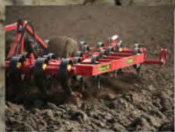
Erős, hidraulikusan állítható Crossboard simító a tökéletes felszínyegyengetés érdekében
