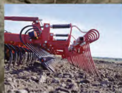
A hátsó CB simító és a követő borona tökéletes lezárást biztosít, nem ragad meg nedves talajon sem
