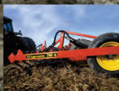
A precíz mélységállításról az ún. Master & Slave rendszer gondoskodik
