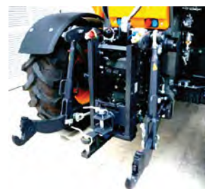
▲ 3 pont függesztés és vonószervezet
