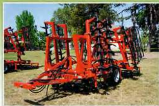
SA ásóboronák 1,8-tól 8,4 m munkaszélességig, 3 sor késtengellyel, 2 sor törőhengerrel, bóracél ásókésekkel, öntvény csapággal szerelve.
