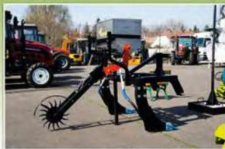
Vakond sormélyműtrágyázó gyümölcsösbe. Állítható munkaszélesség, 180 literes saválló műtrágyaszóró tartály, fülkéből szabályozható elektromos vezérlés.
