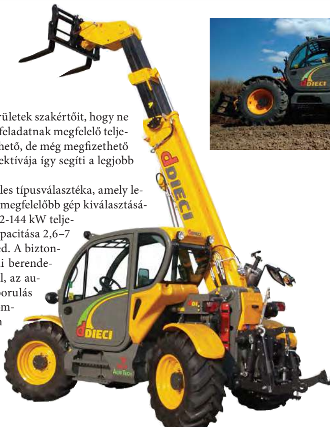
▲ 3 pont függesztés és vonószervezet
