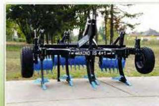
Vakond középnyelűművelők 2-5 kérés kivitelben, tűskés elmunkáló hengerrel.
