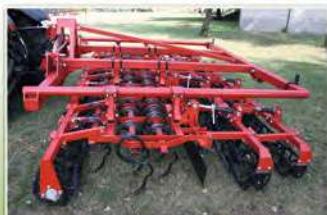
Kombi-Mix magágykészítők 2,8-tól 5,6 m munkaszélességig, robosztus kivitel.
