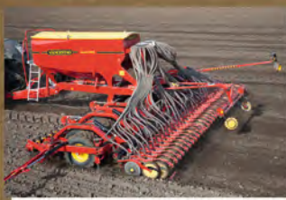
Nagyméretű (820 mm), offset-elrendezésű mellső tömörítő keréksor
