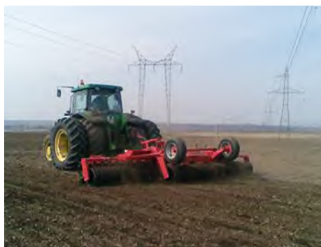
▲ 1. kép: a szántáselmunkálás talajkímélő eszköze a rugós simító-henger kombináció (Fotó: Bottlik).
