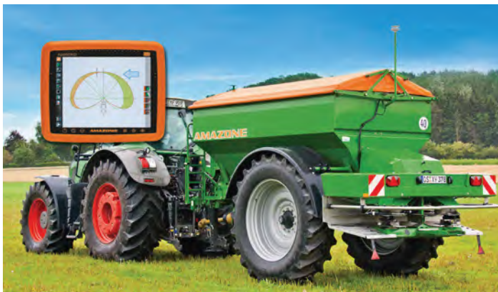
▲ A WindControl célja a szél hatásának csökkentése
