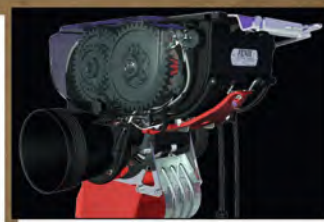
Fenix II. elektromos hajtású magadagoló, akár 1 kg/ha magráta pontos kivetése
