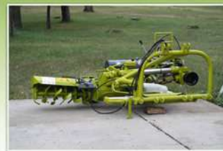
Calderoni FPS oldalazó talajmaró gyümölcsösbe. Maximális kinyúlás traktorközéptől 310 cm.
