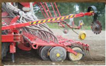
TriForce csoroszlya- felfüggesztés a jobb talajkövetés érdekében
