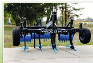
Vakond közép mélyművelők 2-5 késes kivitelben, tűskés elmunkáló hengerrel.
