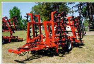
SA ásóboronák 1,8-tól 8,4 m munkaszélességig, 3 sor késtengellyel, 2 sor törőhengerrel, bőrcél ásókékekkel, öntvény csapággal szerelve.
