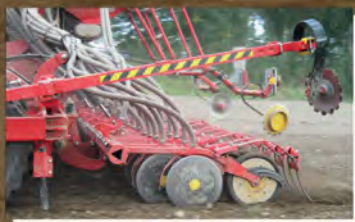
TriForce csoroszlya- felfüggesztés a jobb talajkövetés érdekében
