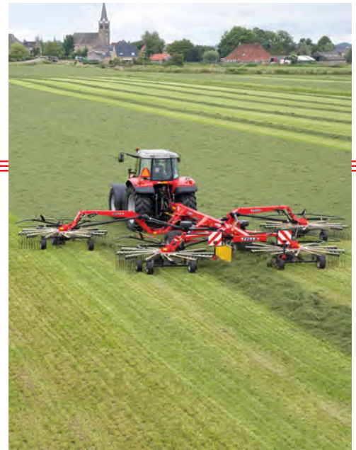
▲ 2. kép: 12,5 m munkaszélességű Fella TS 12555 PRO rendrakó
