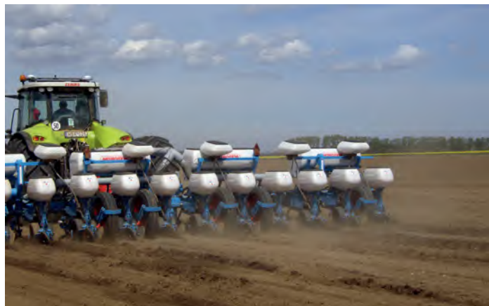
▲ Kukoricavetés 2012. április 20-án: GPS vezérelt, automata kormányzású, automata sorrelzárással kombinált Claas traktor és műtrágya kijuttatóval is felszerelt Monosem vetőgép
