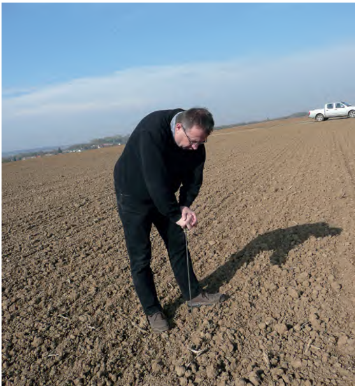
▲ 1. kép: Szűcs Imre, a Belvárdgyulai Zrt. termelési igazgatója és igazgatóságának elnöke a lazult réteg mélységét ellenőrzi pálcaszondával
