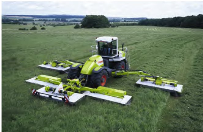
▲ 1. kép: 14 m munkaszélességű Claas Cougar 1400 kaszákombináció
