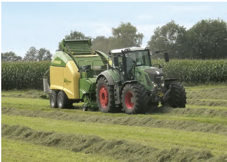
▲ 3. kép: folyamatos üzemmódú Krone Ultima CF 155 XC bálázó-csomagoló
