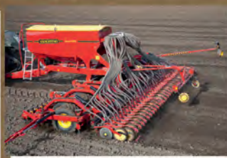
Nagyméretű (820 mm), offset-elrendezésű mellső tömörítő keréksor
