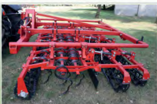
Kombi-Mix magágykészítők 2,8-től 5,6 m munkaszélességig, robosztus kivitel.
