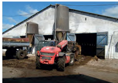
▲ 2. ábra: kitrágyázási munkákra jól használhatók az alacsony építésű teleszkópos homlokrakodók
