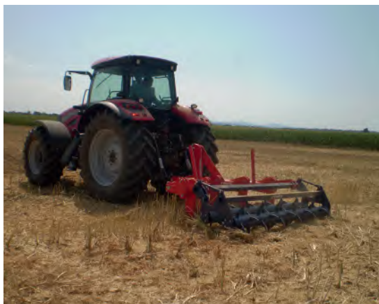
▲ A rögaprításról az újonnan alkalmazott hengersor gondoskodik
