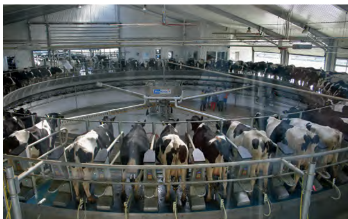
▲ A Xcalibur 360EX körforgó rendszerű fejőberendezés működés közben. Napi 6600 fejés az év 365 napján
