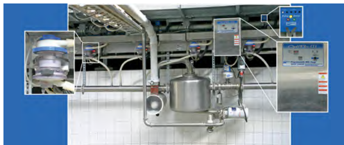
▲ A körforgó fejőberendezés belső pereme mentén elhelyezett egységek. Külön kiemelve a tejmérők (balra), a Pulse-O-Rater (jobbra fent) és a tejszivattyú programozható vezérlője (jobbra középen)
