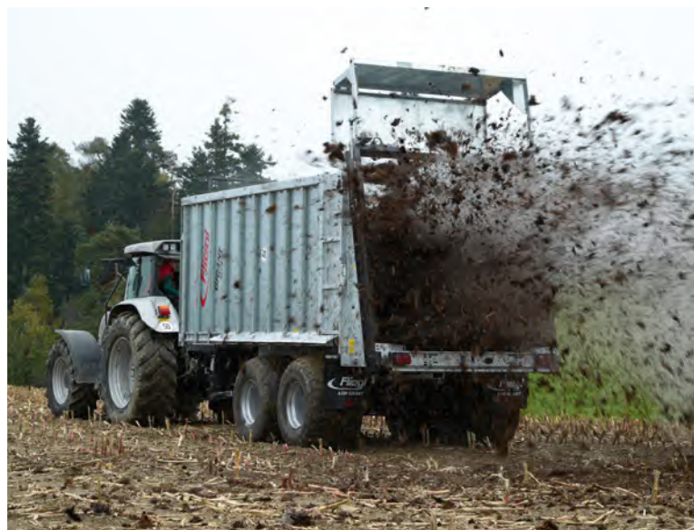
▲ 3. kép: Fliegl szerves trágya szórás, ASW letoló technikájú pótkocsival, amely különböző adapterek segítségével szállítóeszköz és átrakó kocsis egyben
