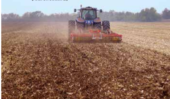
2. kép: talajvédő mulcsművelés kukorica után nehézkultivátorral (Fotó: Dr. Bottlik L.)
