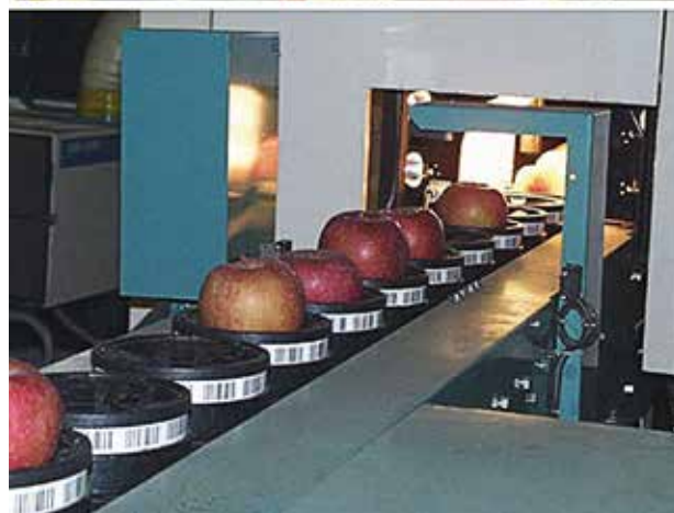
3. ábra: In-line NIR-technika a folyamatszabályozás (húsfeldolgozás és gyümölcsosztályozás) szolgálatában
