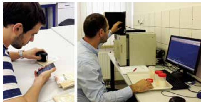
3. ábra: mérés egy DLP technológiára alapozott kézi NIR spektrométerrel (balra) és egy nagy precízitású diszperziós asztali NIR spektrométerrel (jobbra)
