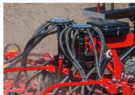
Dupla elosztófej, fülkéből kapcsolható félgép-lezárás
