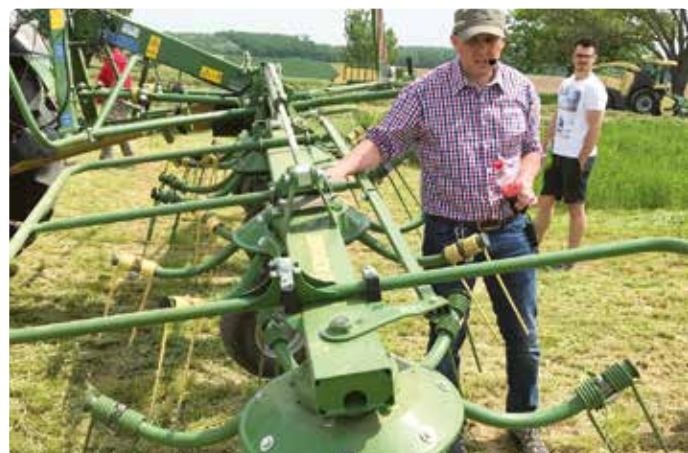
A KW sorozatú rendterítők „Lift” ujjai kíméletes anyagkezelést végeznek
