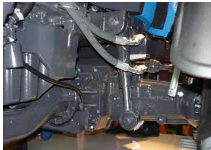
A rugózott első híd biztosítja a nagyobb komfortot a gépkezelő számára.
