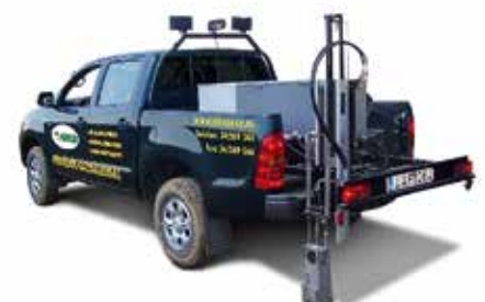
2. ábra: standard fúró és rétegfúró, valamint a gépi mintavevő berendezés
