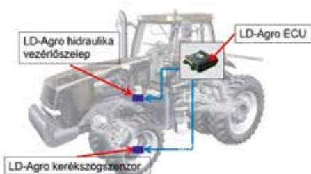
3. ábra: LD-Agro Hydraulic robotpilóta rendszer (forrás: agrozagda.hu)
