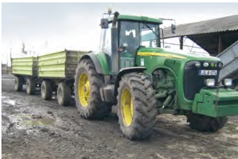
2. ábra: ömlesztett anyagok, szemestermények szállítására összeállított két pótkocsi traktoros szállító gépcsoport
