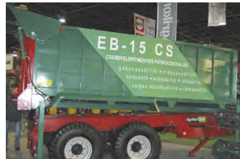
3. ábra: a hazai gyártású különleges kialakítású, emelve billenő kocsiszekrényvel és különböző cserefelépítményekkel rendelkezik
