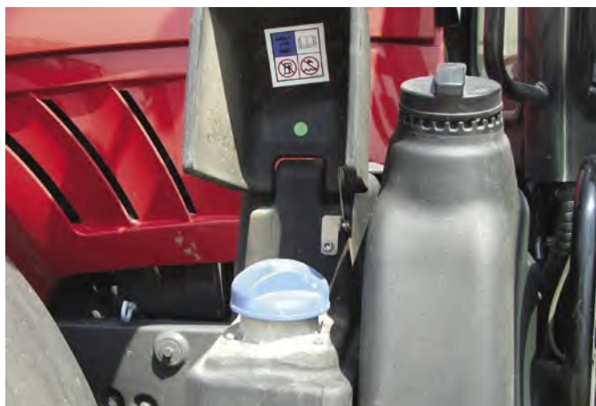
AdBlue tartály az üzemanyagtank mellett.
