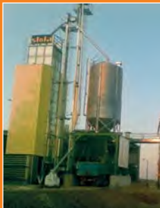
Zalabér-Batyk • MDB-TN-1/8-S, 10 t/h, Marot tisztító, Skandia szállítógépek, Symaga silók
