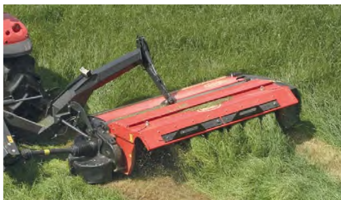
▲ Vicon Extra 632 T „húzott” rendszerű felfüggesztési módja
