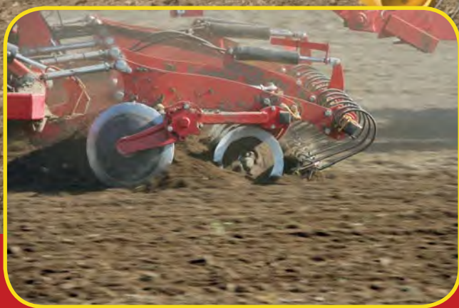
Crossboard simítóval is kombinálható tárcsás magágykészítő egység
