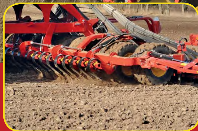
800 mm átmérőjű, offset elrendezésű mellső tömörítő keréksor
