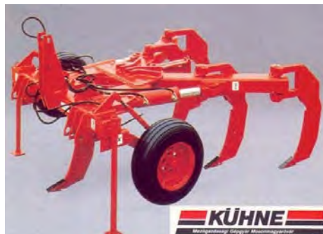
▲ 5. ábra: VFK változtatható fogásszélességű középmeélylazító
