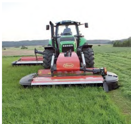
▲ Vicon Extra 632 T és 632 FT kasza-kombináció 6,2 m-s munkaszélességgel
