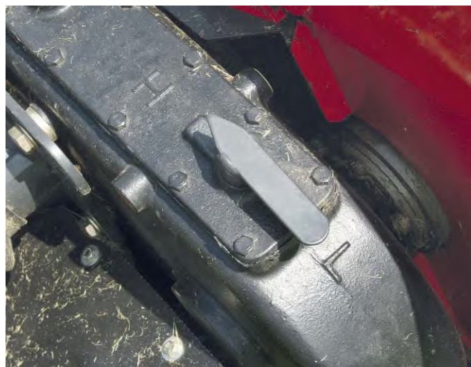
▲ Változtatható fordulatszámú szársértő hajtóműve
