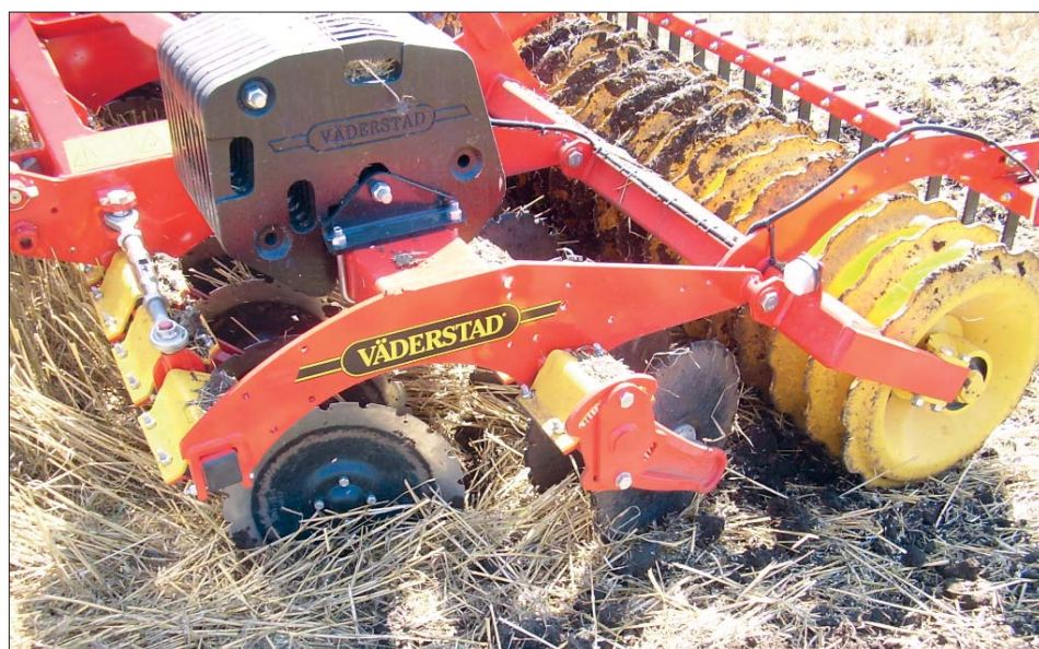
▲ 1. kép: a tarlóművelés célgépe a síktárcsa
