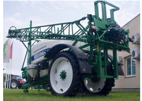
▲ Vontatott permetező 4000 literes tartállyal, 24 méteres kerettel
