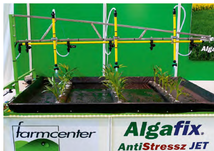
▲ Az Algafix AntiStressz JET adapterei, amelyek egyszerűen felszerelhetők a permeterizógépre és lehetővé teszik a növény-sorok permeterizését
