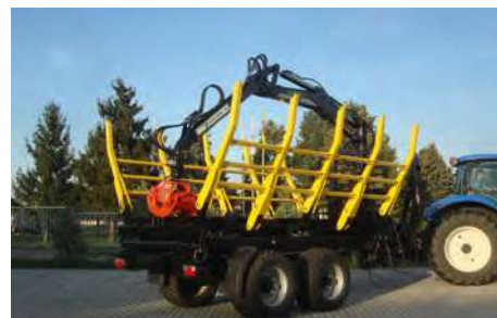
▲ A járószerkezet és a felépítmény kialakításának köszönhetően a kihordó alkalmazkodik a mostoha útviszonyokhoz
