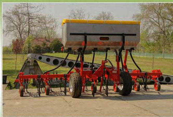
SUK kultivátorok műtrágyaszóróval 3, 4, 6 illetve 8 soros kivitelben. Hidraulikus vagy kézi csukással, rugóskapás vagy merevszáras kapával. Frontra szerelhető kivitelben is! Tartálytérfogat: 2x180, illetve 1000 liter.
