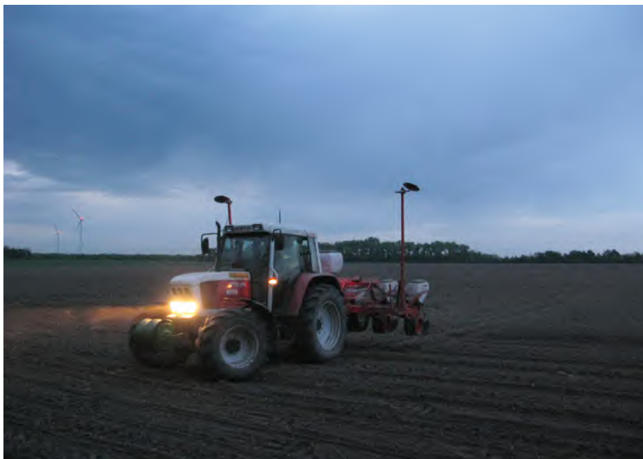
▲ 1. kép: RTK-jellel, automatikus kormányzással végrehajtott vetés
