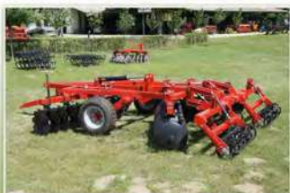
X vagy V elrendezésű vontatott tárcsák elmunkáló hengerral.
