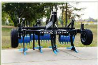
Vakond közép mélyművelők 2-5 éves kivitelben, tüskés elmunkáló hengerral.
