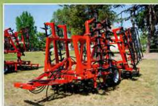
SA ásóboronák 1,8-től 8,4 m munkaszélességig, 3 sor késtengellyel, 2 sor törőhengerral, bóracél ásókésekkel, öntvény csapággal szerelve.
