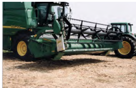
▲ 4. kép: John Deere Premium Flow hosszirányú behordó szalagos vágóasztal Zürn oldalvágó kaszával
