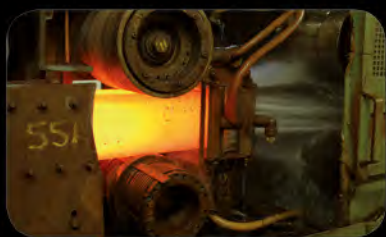
A gerendely indukciós hőkezelése
