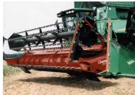
▲ 2. kép: Geringhoff Varia Star VS 670 kitolható vágószerszerkezetű vágóasztal baloldali oldalvágó kaszával
