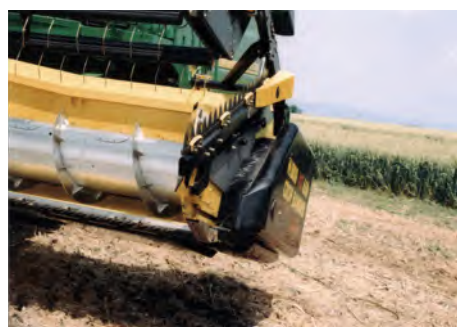
▲ 1. kép: oldalkaszákkal szerelt Biso VX Crop Ranger VX 650 „vario” vágóasztal oldalvágó kaszával
