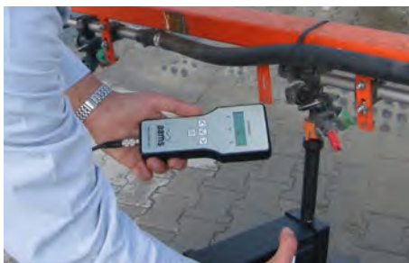
▲ A fűvókák teljesítménye egyenként, szempillantásnyi idő alatt mérhető
