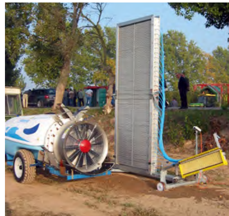
▲ Függőleges bemérő fal
