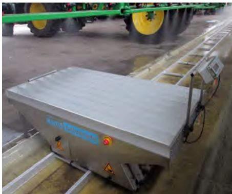
▲ A szórókeret fűvókái alatt sínen önmagát vezérelve mozog a bemérő vályúsor
