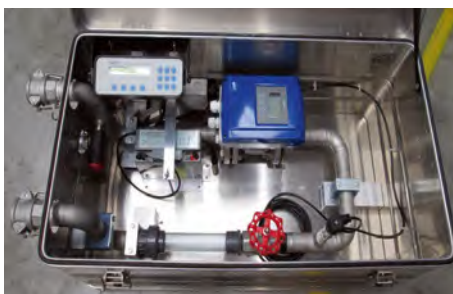
▲ A szivattyú szállítást és nyomását mérő bőrönd
