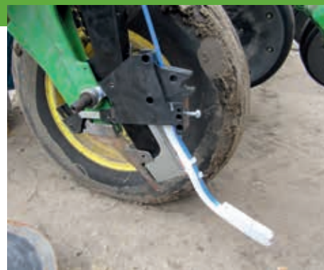
▲ A vetésellenőrző szenzor elhelyezkedése közvetlen a talaj felett
