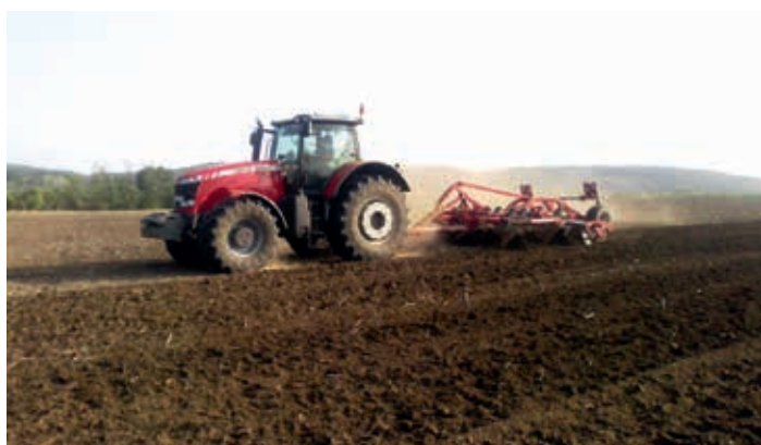
▲ 3. kép: a grubberekkel elérhető a 30 cm körüli munkamélység (Fotó: Bottlik)
