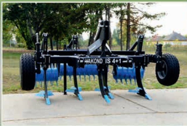
Vakond közép mélyművelők 2–5 késes kivitelben, tüskés elmunkáló hengerrel.
