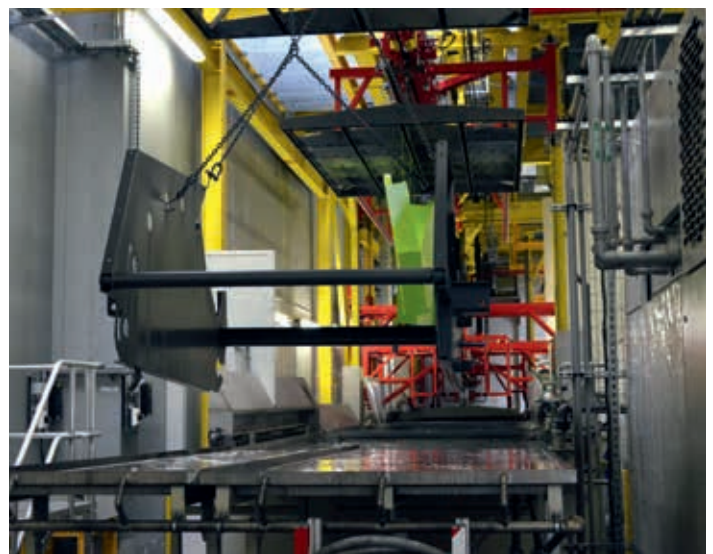
▲ Bálázó oldalfalának előkészítése az új üzemben
