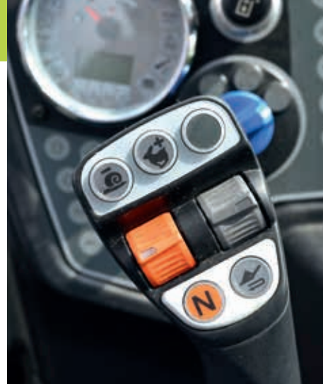
► A rakodó kezelése kényelmesen történhet a joystick-ról
