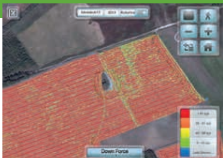
▲ Az iPad-en megjelenített talajellenállás térkép a táblán belüli különbségeket mutatja meg
