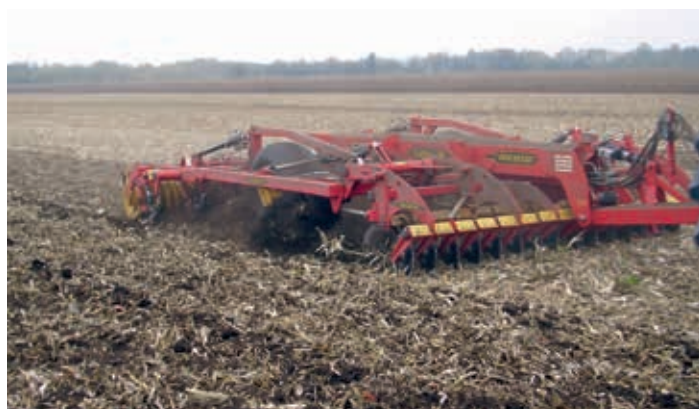
▲ 4. kép: a talajvédő művelés célja a nehézkultivátor (Fotó: Bottlik)
