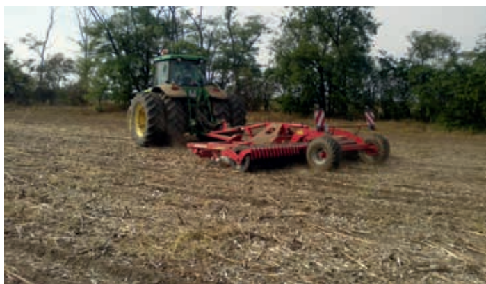
▲ 2. kép: a rövidtárcsákat az őszi bekeverő jellegű tarlóhántásra is használhatjuk (Fotó: Bottlik)
