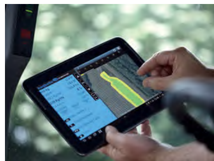
▲ iZurf - Bogballe műtrágyaszóróját akár egy közönséges tablet-ről vezetik nélküli kapcsolattal szabályozhatja
