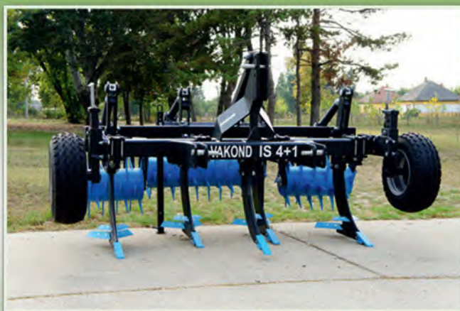
Vakond középmezőművelők 2–5 késes kivitelben, tüskés elmunkáló hengerrel.
